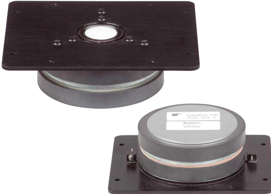
Auffällig an diesem Hochtöner aus den USA ist vor allem die weiße Keramik-Kalotte, die sich auf der schwarzen Frontplatte gut abhebt und fast wie ein Auge wirkt. Die Front ist aus Aluminium gefertigt und besticht durch ihre massive Bauweise. Bei der Keramik der Kalotte handelt es sich um gesintertes Aluminiumoxid.
