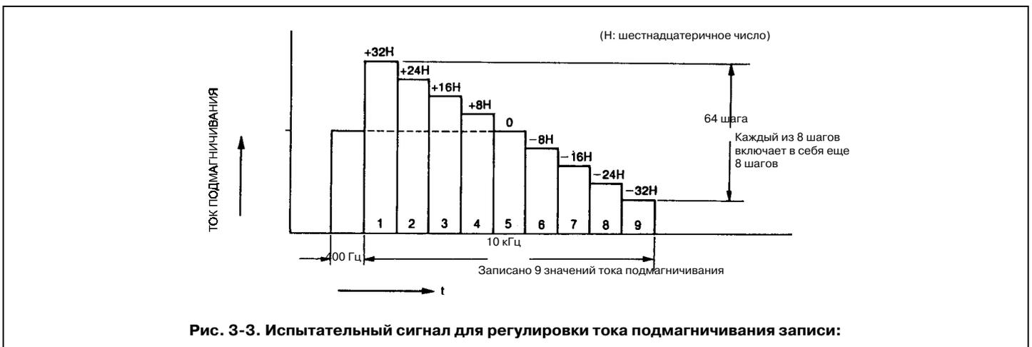
**Рис. 3-3. Испытательный сигнал для регулировки тока подмагничивания записи:**
