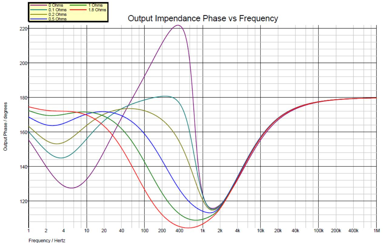
Как видно из графика уменьшение значения R1 в разумных пределах (до 200-100 мОм) вызывает небольшое колебание фазы выходного напряжения на частотах 1-20 Гц (обусловлено малой емкостью C1 и большими значениями R3/R4), и меньшее изменение фазы в диапазоне 40Гц-2кГц.
