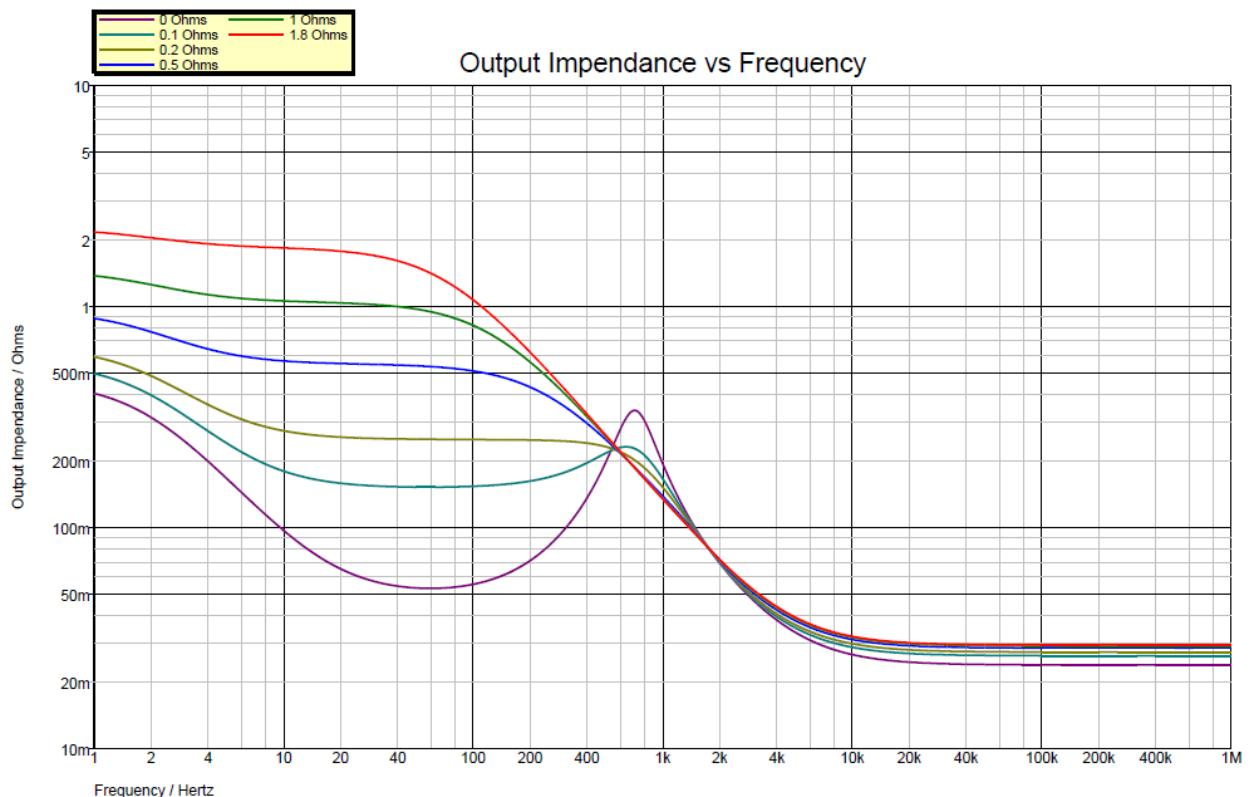
Как видно из графика уменьшение значения R1 в разумных пределах (до 200–100 мОм) позволяет значительно снизить выходное сопротивление стабилизатора на частотах до 500 Гц без образования резких пиков и провалов.
