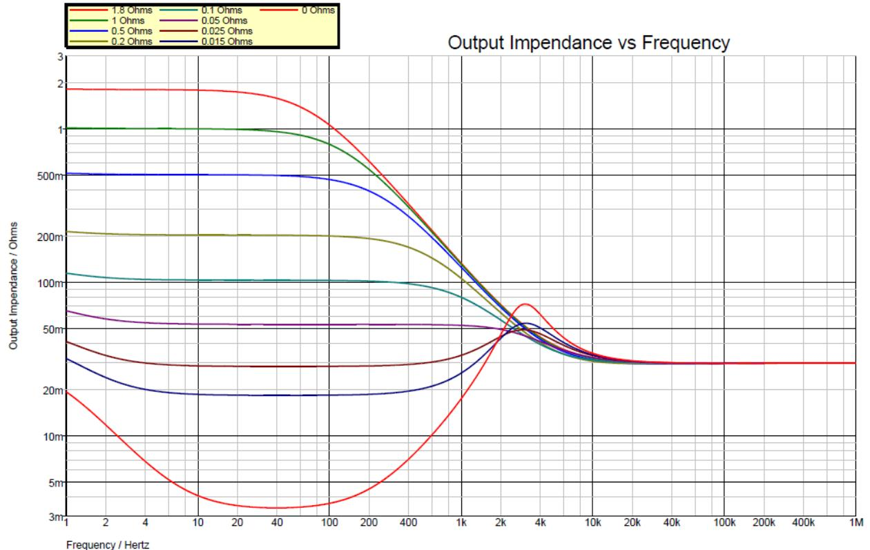
Как видно из графика, выходное сопротивление стабилизатора в диапазоне до 1кГц стало более линейным. Уменьшение резистора R1 ниже 50 мОм, приводит к появлению резонансного пика на частоте 3 кГц. Исходя из данных графика, оптимальным значением R1 является значение в диапазоне 50-100 мОм.
