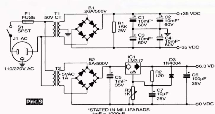
нагрузке 8 Ом. Схема блока питания, обеспечивающего  $\pm 35$  В \ 6 А для основного питания и 6,3 В \ 0,5 А для накала V1, показана на **рис. 9**. Выходную мощность можно увеличить до 50 Вт простым добавлением пары выходных транзисторов параллельно указанным на схеме штриховой линией («*AudioXpress*» №5/2001, с. 18, 20).
