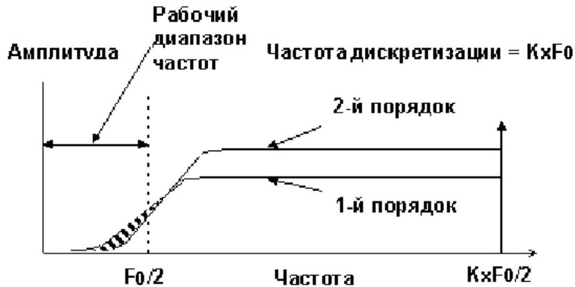
Рис. 3.20. Функции распределений спектров шума для модуляторов первого и второго порядков
