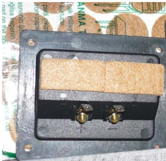
Фото 11. Доработанный аудио терминал.
