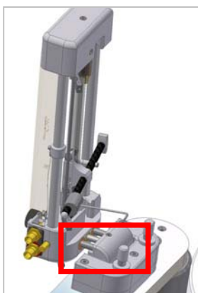
Abb.13: Befestigen der Gegengewichte
