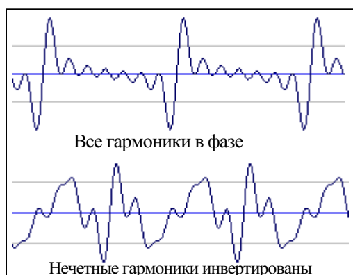
Рис.3.6. Сигналограммы сигналов из 7 гармоник равного уровня
