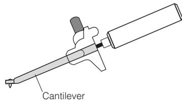
Das Nadelsystem eines Tonabnehmers besteht im Wesentlichen aus den drei Bauteilen Nadel, Nadelträger und Aufhängung. Der Nadelträger ist ein winziger, flexibel aufgehängter „Arm“ (massiv oder hohl), auf dessen Ende die Diamantnadel sitzt. Er überträgt die Schwingungen der Nadel zu den Magneten (MM-Systeme) bzw. zu den Spulen (MC-Systeme). Für Nadelträger werden verschiedene Materialien verwendet: Aluminium, Saphir, Beryll, Bor ... je leichter und steifer, desto besser.
