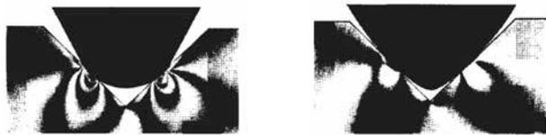
Aufnahmen einer Spannungsanalyse verdeutlichen die Wirkung einer Auflagekraft von 2 Gramm. Die elliptische Nadel (links) berührt die Rille in einem konzentrierten Bereich mit hohem Druck. Die MicroLine™-Nadel (rechts) berührt die Rille in einem größeren Bereich, wodurch weniger Druck ausgeübt wird und der Plattenverschleiß abnimmt.
