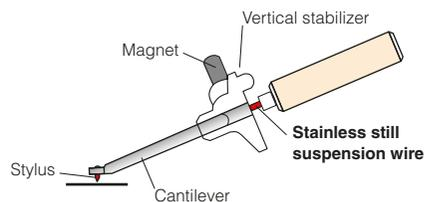
Der Tonabnehmer **AT5V** verfügt über den **Edelstahlspanndraht** des Tonabnehmers **AT150MLX** und eine Stellschraube für die Nadelnachgiebigkeit.
