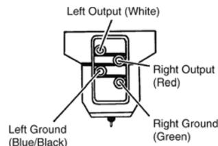
Um einen Tonabnehmer zu installieren, verbinden Sie die vier Kabel der Headshell mit den korrekten Anschlusskontakten auf der Rückseite des Tonabnehmers. Die Kabel sind normalerweise wie folgt farbkodiert:
