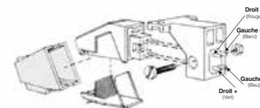
Montage der Modelle **AT311EP** oder **AT300P** an einer ½"-Standardheadshell mittels des U-Mount-Adapters **P20020**.
