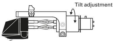
Die Neigung bezeichnet den Winkel zwischen der Plattenoberfläche und der vertikalen Achse des Tonabnehmers. Für eine optimale Kanalbalance sollte dieser Winkel 90 Grad betragen.
