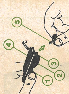
Рис. 4. Замена иголки в головке звукоусилителя
