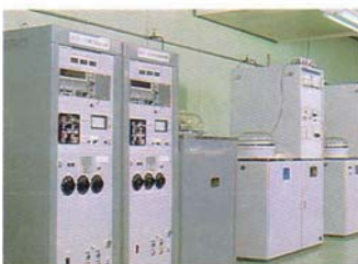
Комната климатических испытаний. Комната для тестирования оборудования, которое может быть использовано при различных условиях окружающей среды.
