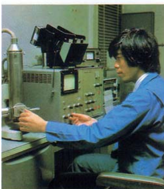
Электронный микроскоп сканирующего типа. Электронный микроскоп для прецизионного измерения формы иглы.
