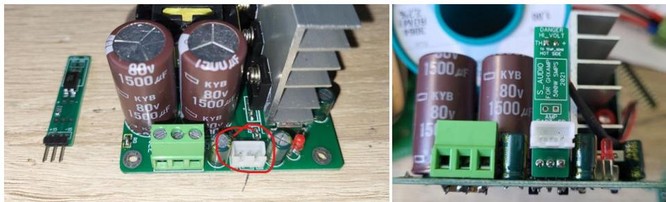
2. Подключение верхних выводов платы доработки к схеме управления блоком питания.
