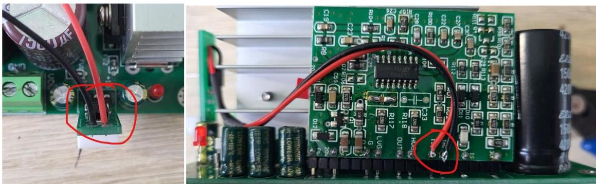
3. Подключение усилителя к доработанному блоку питания
