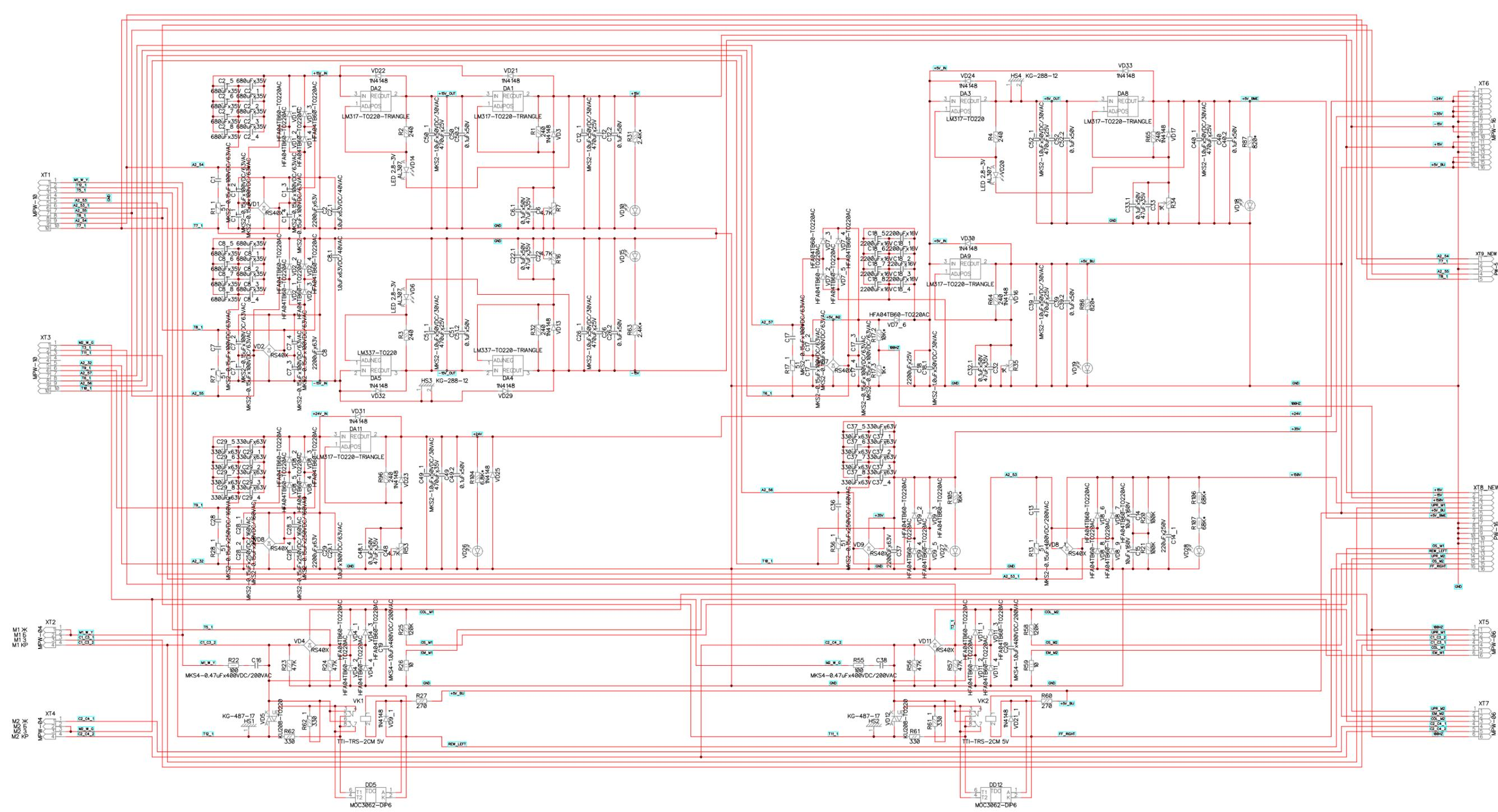
VD6, VD14, VD20 — ОБЯЗАТЕЛЬНО !!! напряжение падения на светодиоде 2.8 – 3 Вольта.
