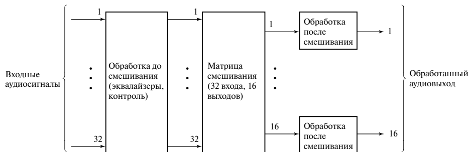
Рис. 1.7. Упрощенная блок-схема цифровой стереосистемы микширования на 32 входа и 16 выходов
