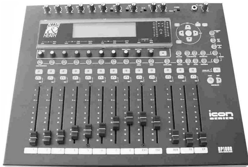
Рис. 1.8. Средства управления на обычном 8-канальном микшере (напечатано с разрешения компании Allen & Heath, Корнуолл, Великобритания)
