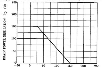
В этом случае транзисторы выйдут за пределы температурного режима. При средней температуре кристалла около 70ти градусов мощность на одну пару транзисторов составляет примерно 100 Ватт. При питании +-70 В, с четырьмя парами транзисторов, мощность отдаваемая на 4 Ом — 400 Ватт, для 2х омной нагрузки при таком питании потребуется 8 пар транзисторов, либо уменьшение напряжения питания.
