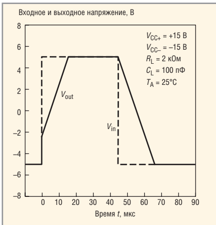
Рис. 18. График переходного процесса повторителя напряжения на ОУ μA741
