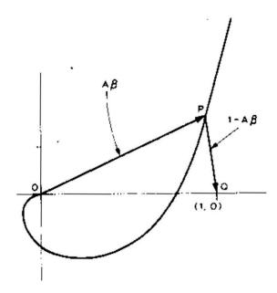
Рис. 5. Диаграмма Найквиста, показывающая что для точек на кривой вблизи (1,0) радиус-вектор ОР становится длиннее PQ, так что усиление с обратной связью значительно превышает 1/ß и с ростом частоты усиление растет до пикового значения, а затем падает.
