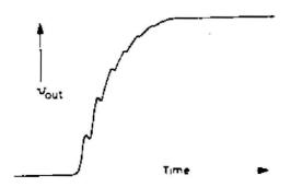
Рис. 4. Типичный отклик на ступеньку аудиоусилителя типа того, что на рис. 3a, с большим значением C и малым запасом по устойчивости.
