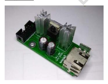
На фотографии показан выходной модуль для активного режима. Модуль соединяется с основной платой 10-проводным плоским шлейфом.
