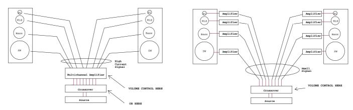
В первом случае, источник сигнала, кроссовер и многоканальный усилитель, находятся в одном месте, и усилитель соединяется с акустическими системами (AC) соответствующими акустическими кабелями. Во втором случае - усилители вынесены поближе к AC, и соединяются с источником и кроссовером межблочными кабелями, а акустические кабели короткие (или усилители могут быть вообще встроены в AC).
