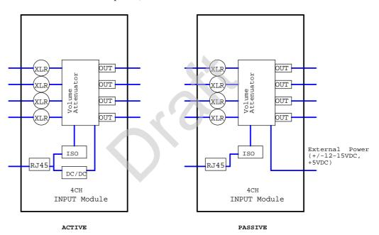
Управляющий блок, расчитанный на работу в активном режиме, может использоваться также и в пассивном, но не наоборот. Различие между ними - в наличии радиаторов на выходных модулях и требуемая мощность питания управляещего блока.
