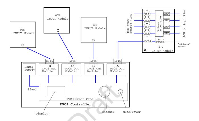
Для регулировки громкости используется 4-х канальный входной (или регулирующий) модуль (Input Module) с балансными входами и квазибалансными (см. ниже) выходами. Принцип регулировки громкости - управляемый цифровым кодом аттенюатор на базе перемножающего ЦАПа (MDAC - Digital-to-Analog Converter).
