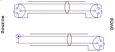
Выход может быть подключен к усилителям как с балансными так и с небалансными входами:
