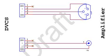
Для выхода используется т.н. "квазибалансное" соединение, которое полностью равносильно "настоящему" балансному, с точки зрения помех на кабель, но более простое в реализации. Отличие от "настоящего" баланса в том, что в "настоящем" используются дифференциальные сигналы (т.е. два активных, взаимно инверсных аналоговых сигнала), а в "квази" используется только один активный сигнал, а источник второго сигнала пассивный, с выходным импедансом эквивалентным выходному импедансу активного.
