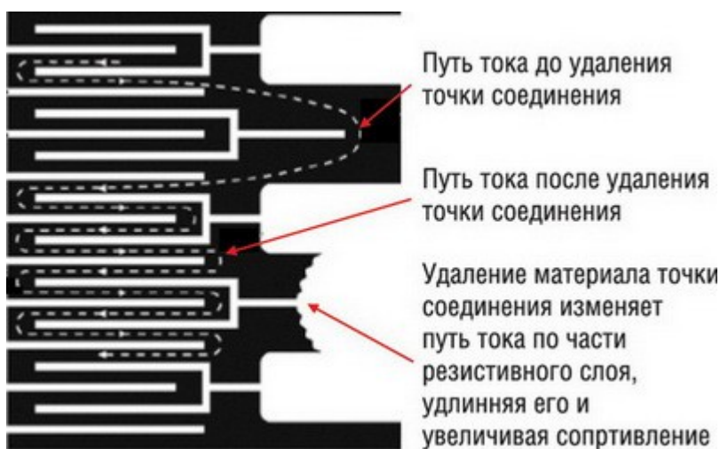
Рис. 4. Схематичный путь тока по резистивному слою (черные области – слой фольги)
