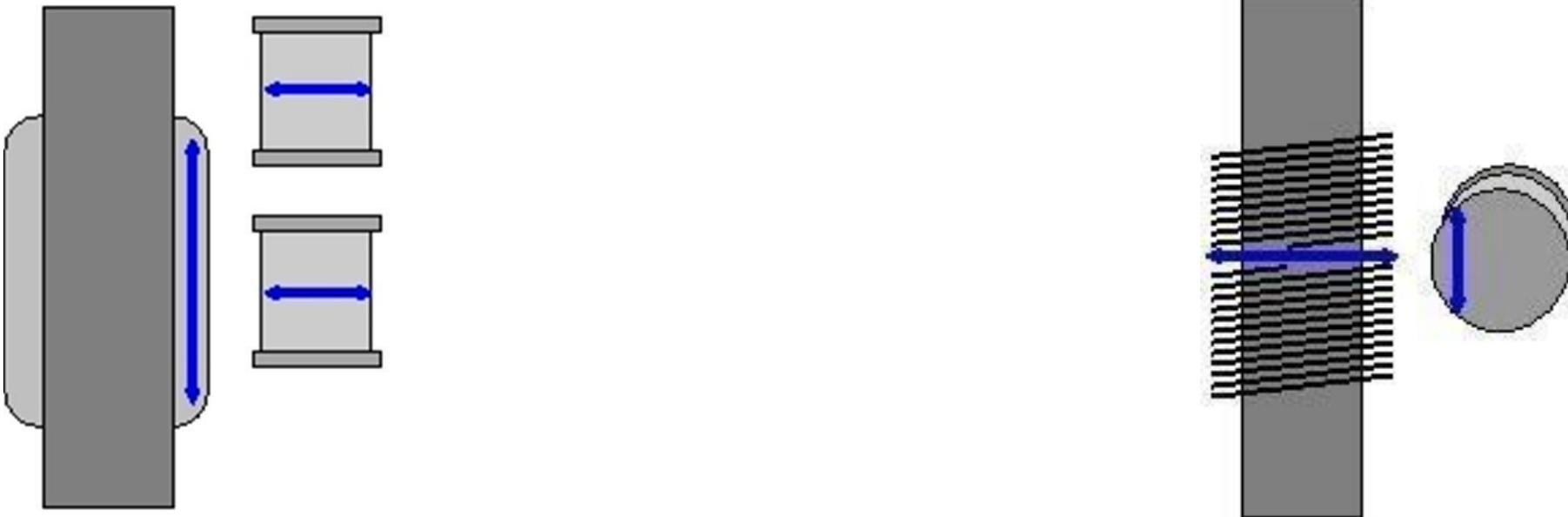
Auch die Wickelrichtung von Spulen mit Trafo- oder mit I-Kern sollte senkrecht zu der des Nachbarn stehen.
