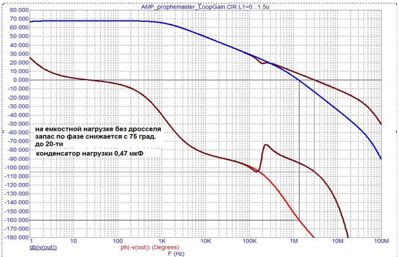
Без дросселя на выходе даже на небольшой дополнительной реактивной нагрузке запас по фазе снижается к критическому значению.
