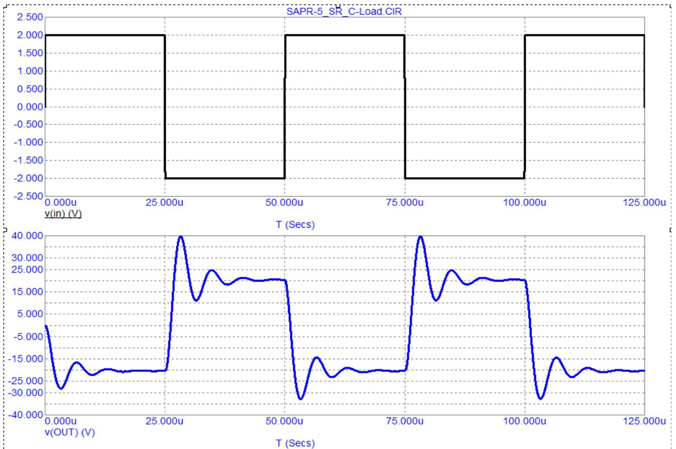
С дросселем и конденсатором нагрузки 0,47 мкФ на полках меандра появляется звон амплитуда которого превышает амплитуду меандра в 2 раза
