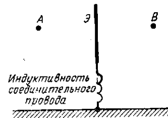
Рис. 2.7. Влияние индуктивности провода, соединяющего экран с корпусом.
