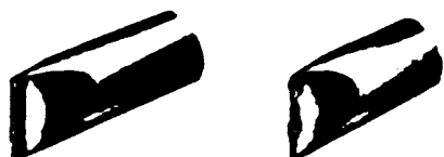
Рис. 127. Рабочий конец жала паяльника (слева — правильно заточенный, справа — выгравший)
