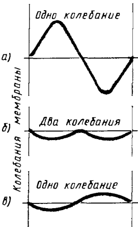
Рис. 47. Графики, иллюстрирующие работу телефона: а — переменный ток в телефоне; б — без постоянного магнита; в — с постоянным магнитом.
