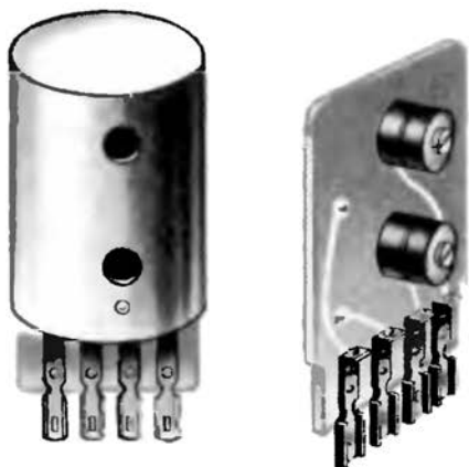
Рис. 238. Фильтр промежуточной частоты
