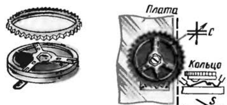
Рис. 202. Конденсатор КПК-2 в роли конденсатора настройки и выключателя питания
