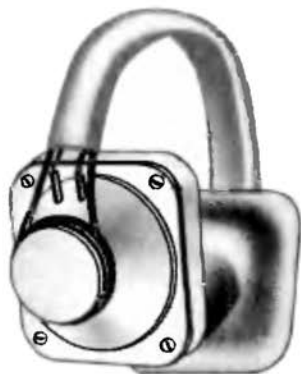
Рис. 316. Самодельные стереофонические головные телефоны
