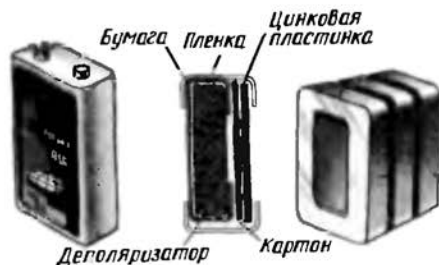
Рис. 161. Батарея «Крона ВЦ» и гальванический элемент галетного типа (в увеличенном виде)
