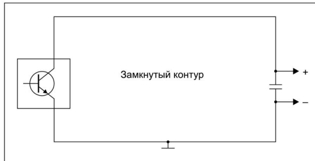
Рис. Возникновение замкнутого контура, образованного шиной «земли» и питания
