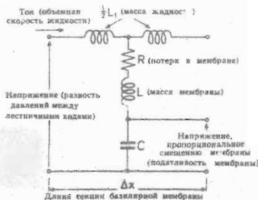
Фиг. 9. Схема небольшой секции базиллярной мембраны, составленная на основе электрических аналогий (одно-волновая модель). На низких частотах ( \omega \ll 1/\sqrt{LC} ) данная секция по существу выполняет функции линии задержки. На высоких частотах ( \omega \gg 1/\sqrt{LC} ) она представляет собой (индуктивный) аттенуатор. При \omega = 1/\sqrt{LC} поперечный ток (соответствующий скорости смещения базиллярной мембраны) имеет резонансный пик. Различные частоты резонируют на различных участках, расположенных вдоль мембраны.
