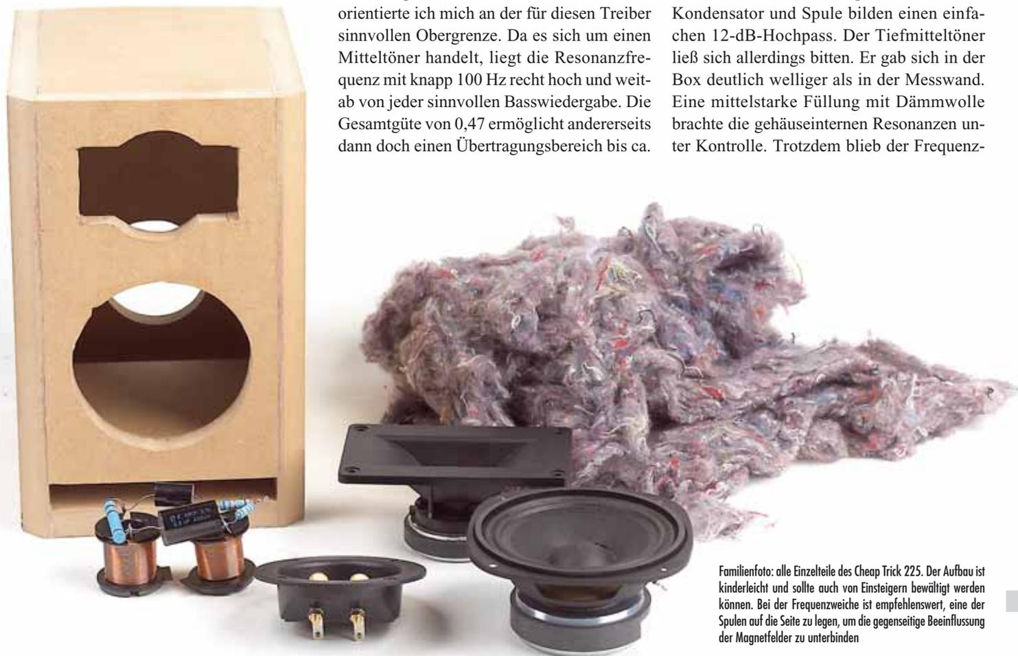
Familienfoto: alle Einzelteile des Cheap Trick 225. Der Aufbau ist kinderleicht und sollte auch von Einsteigern bewältigt werden können. Bei der Frequenzweiche ist empfehlenswert, eine der Spulen auf die Seite zu legen, um die gegenseitige Beeinflussung der Magnetfelder zu unterbinden
