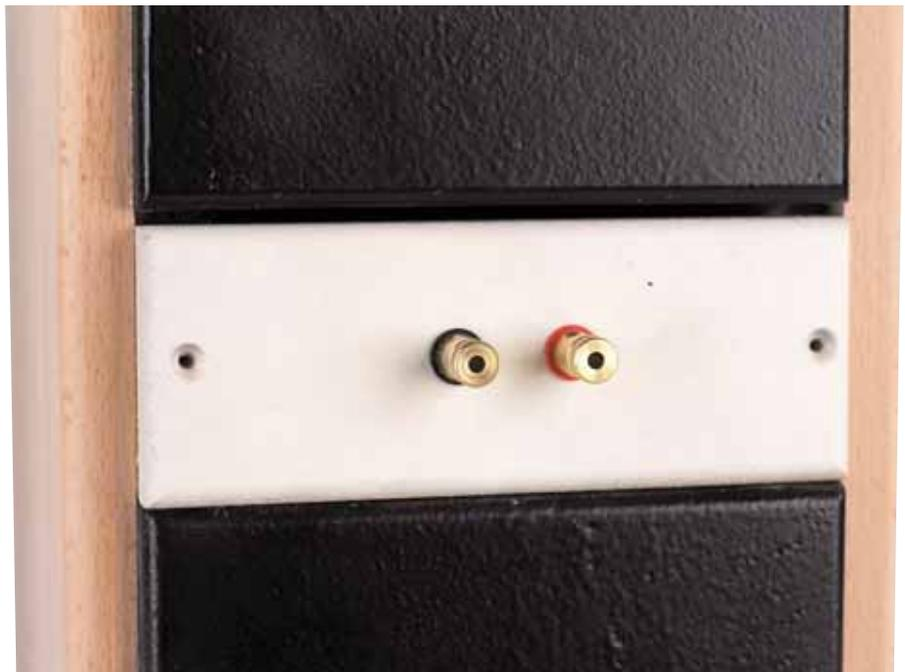
Schraube locker: die Rückseite der Weichenschublade, zur besseren Erkennbarkeit hier noch ganz in weiß, wird in den entsprechenden Trägerplatten mit dem Gehäuse verschraubt. Ein luftdichter Abschluss ist nicht notwendig, da alle Gehäuseabteile in sich schon dicht sind. An dieser Stelle kann man statt einer Schublade natürlich auch ein Fach für die Weiche vorsehen, das später mit Sand befüllt wird
