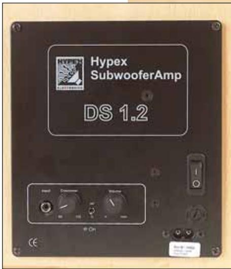
Der Verstärker des Subwoofers ist eine Digitalendstufe von Hypex, mit der wir schon bei den Cheap Tricks 219 bis 221 gute Erfahrungen gemacht haben
