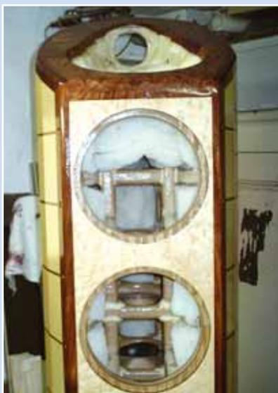
□ Das Bassgehäuse nach dem Lackieren. Sehr schön sind die Versteifungsmatrix und die Dämpfung zu sehen. Auch der Sockel für den Mittelhochton-Teil ist gut zu erkennen
