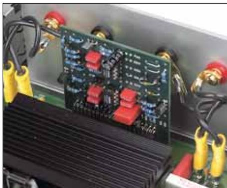
Mit steckbaren Filtermodulen lassen sich die Endstufen zum vollaktiven System erweitern. Die Module werden von Hubert Reith individuell für den Einsatzzweck angefertigt
