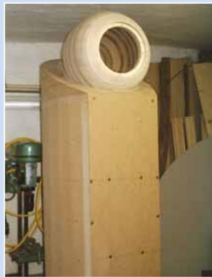
□ Das Gehäuse im Rohbau. Sehr schön ist hier zu sehen, dass die Seiten aus einzelnen, schmalen Leisten aufgebaut sind. Der Mittelton-tropfen ist in das Gehäuse eingelassen
