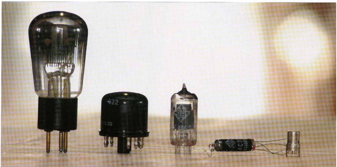
Abbildung 2-15. Röhren RE 084k, VF14, EF86, AC701, 13CW4 (Nuvistor)
