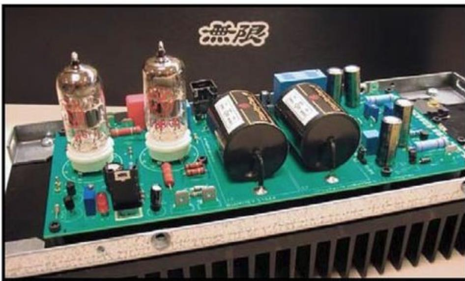
Топология печатной платы позволяет применить в конструкции качественные конденсаторы других производителей, в том числе **Wima** и **Solen**. Значение 3,3 мкФ выбрано для обеспечения спада АЧХ ниже 10Гц. Разделительный конденсатор совместно с входным сопротивлением транзисторного каскада составляют фильтр, частоту среза которого можно определить по формуле:
