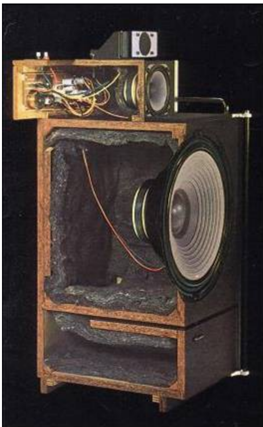
Technics SB 7000 – первая в мире фазолинейная АС, акустическое оформление -резонатор Гельмгольца, материал - НЧ и СЧ трёхслойный арамид.
