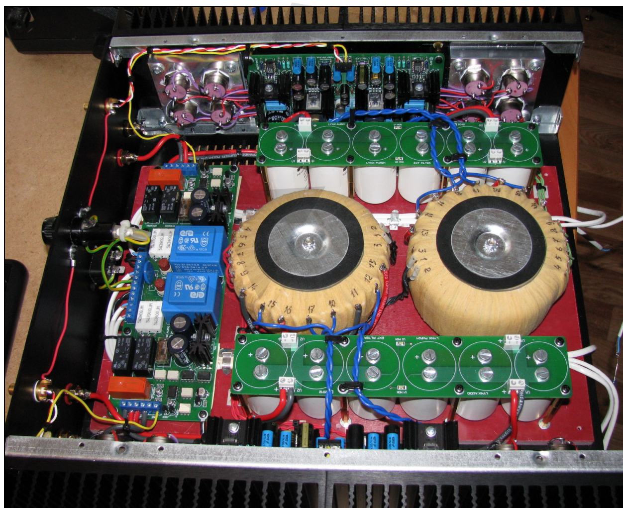
Рис. 7 Усилитель Lynx PA21 в процессе монтажа в корпус
