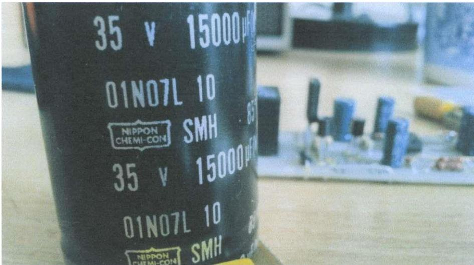
Рисунок 2. Конденсатор фильтра питания выходных транзисторов
