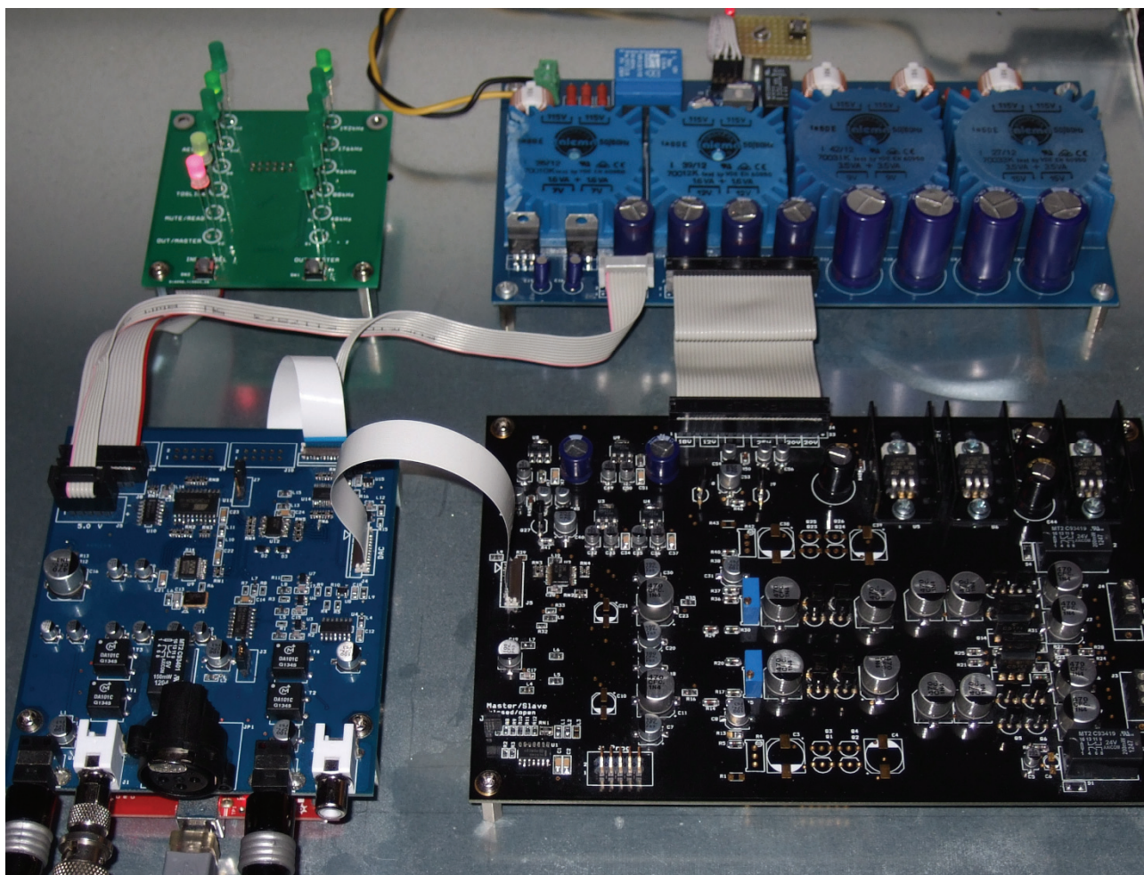
Модуль SPDIF с платой управления в составе отладочного макета универсального ЦАП.
