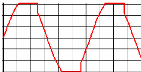
Рис. 3.37. Клипирование сигнала со сквозными токами ВК
