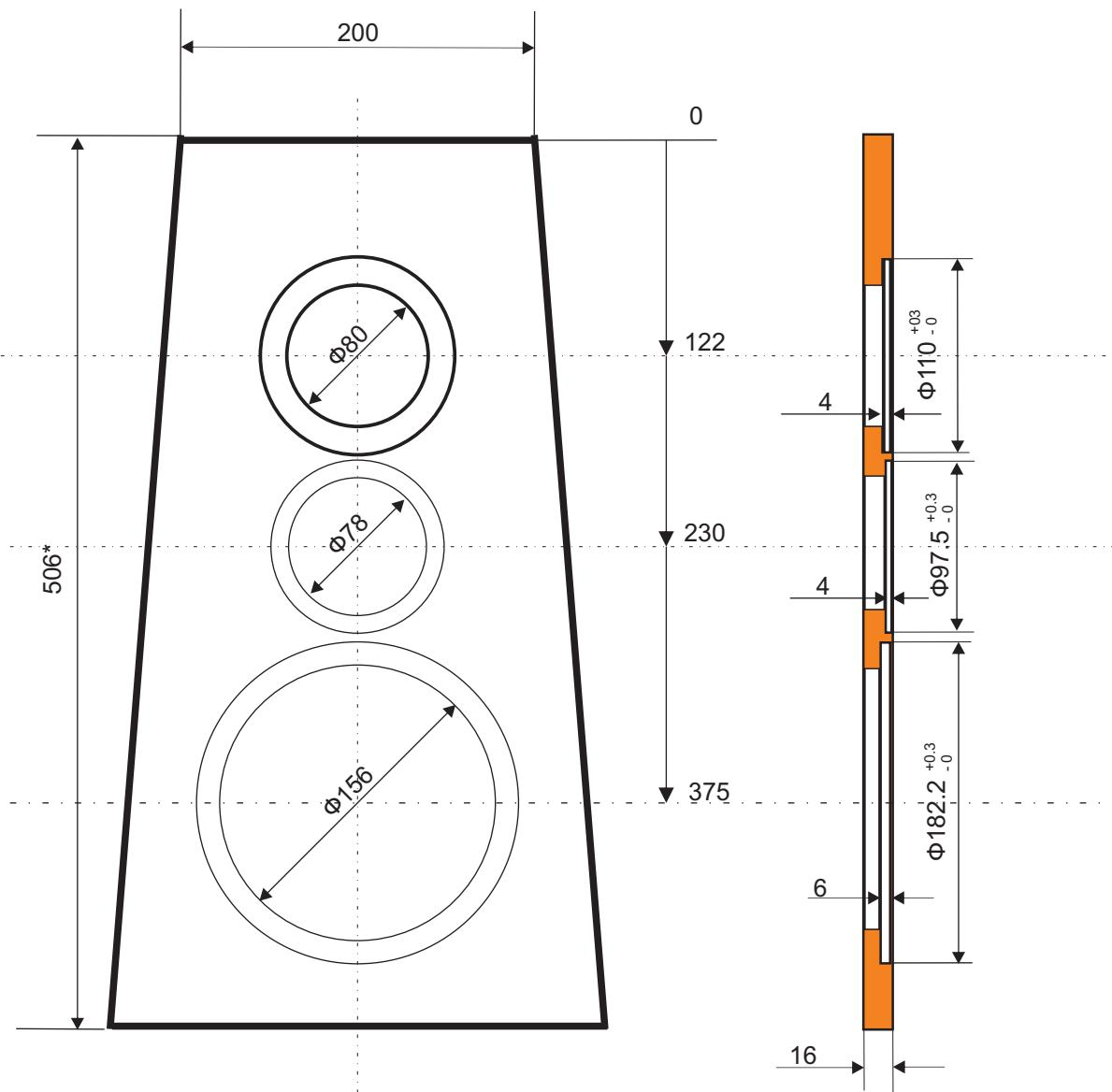
Заготовка передней панели внешняя. МДФ 16мм.
