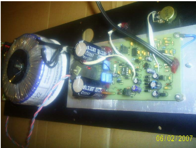
Усилительный модуль 300Вт. Питание трансформаторное. Частота квантования 200кГц. Нагрузка 4 Ом.
