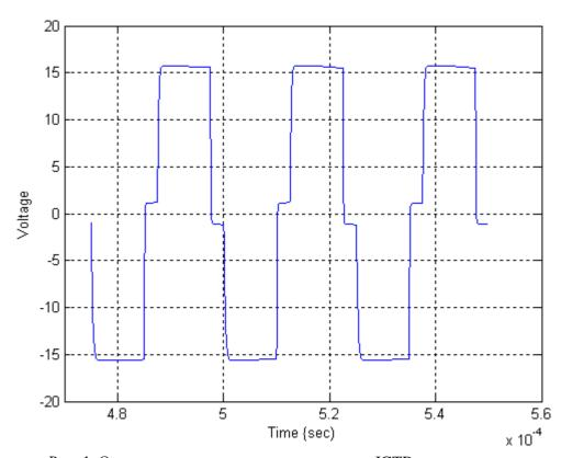
Рис. 1 Осциллограмма напряжения на затворе IGTB при использовании драйвера с двухтактным трансформаторным усилителем.
