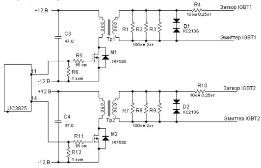
Рис. 2 Схема драйвера для полумоста
