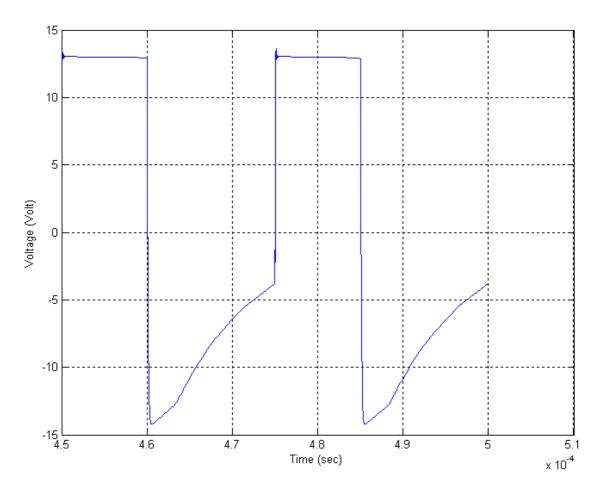
Рис. 3 Осциллограмма управляющего сигнала на затворе IGTB при использовании драйвера с однотактным трансформаторным усилителем.
