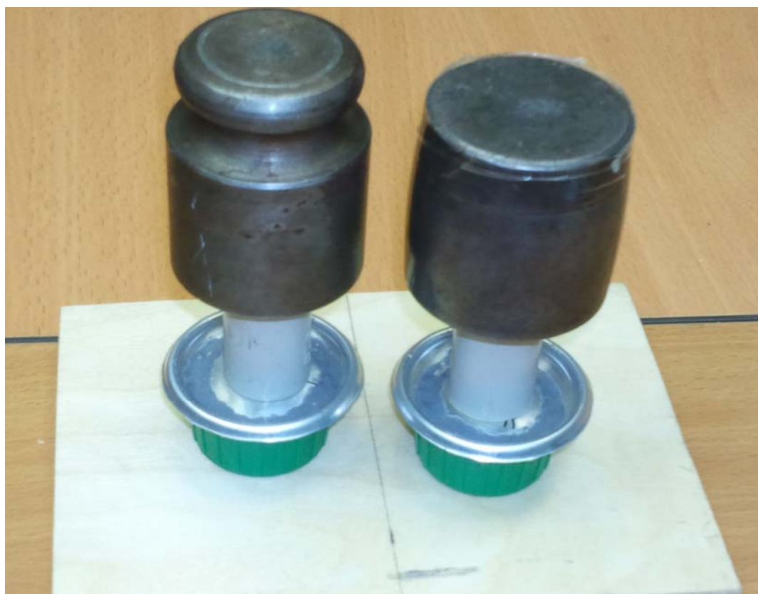
Монтаж внутренней крышки
