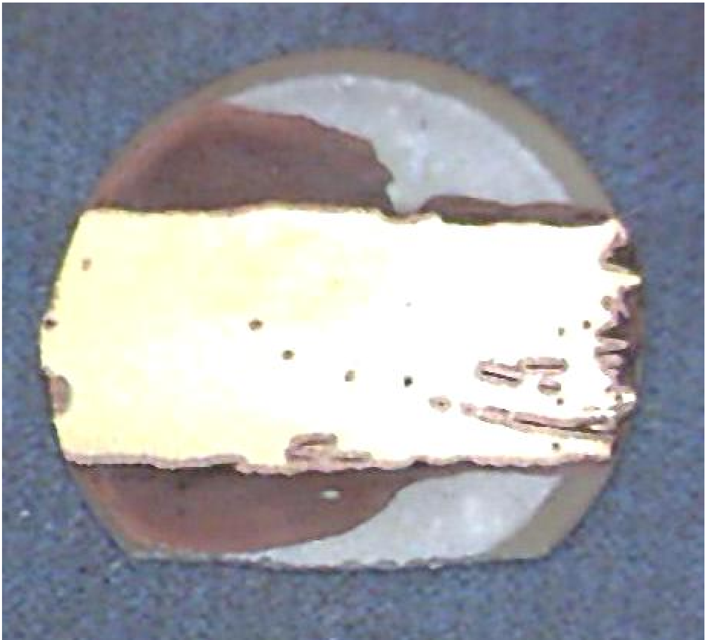
С латунной стороны (специальный экземпляр – травил по времени чтобы посмотреть остатки на ПЭ)
