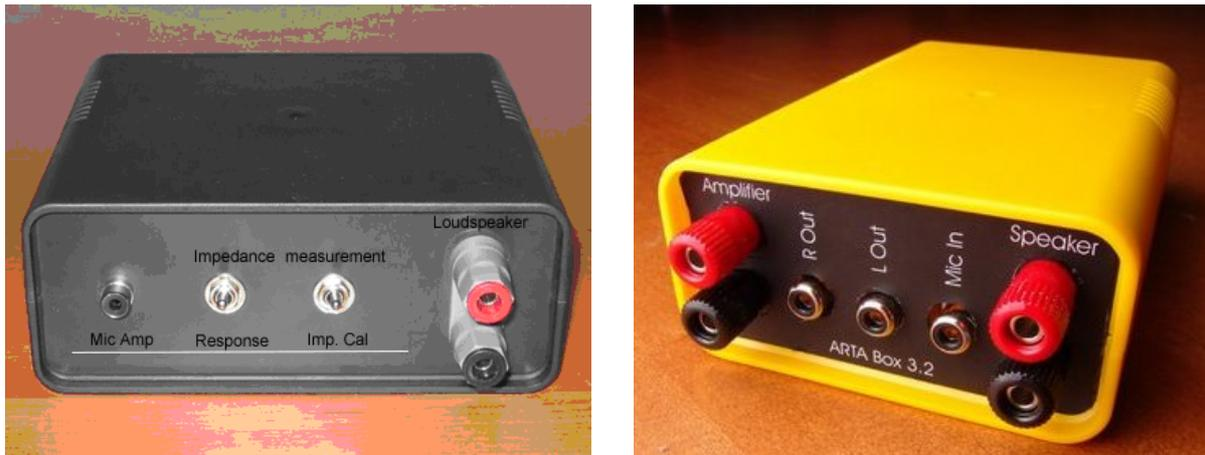
Bild 3.1: Die fertige ARTA-Messbox (links konventionell, rechts Platinenlösung)
