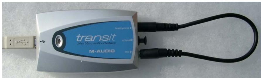
*Loopback Kabel z.B. Pollin Audio Verbindungskabel Stereo, 3,5 mm Klinkestecker auf 3,5 mm Klinkestecker. Länge 0,3 m. Best.Nr. 560 824*
