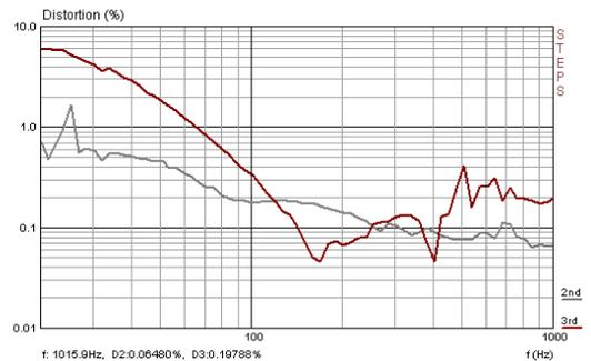
Bild 9.5: STEPS Klirrfrequenzgang eines 6“ TMT im Nahfeld (-6 dB, KE 4-211-2)
