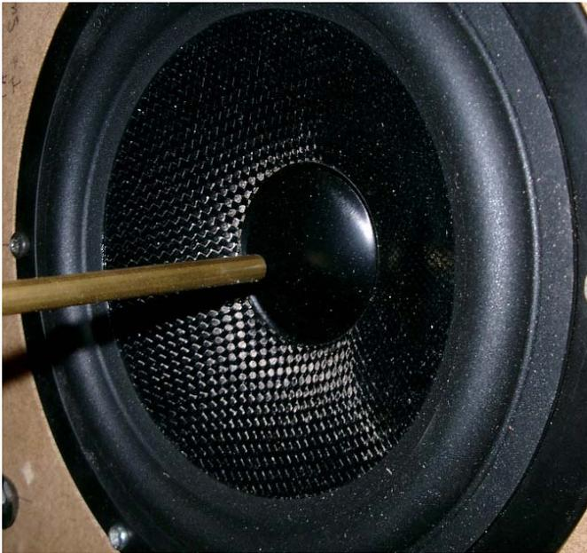
Jetzt führen wir eine zweikanalige Nahfeldmessung mit STEPS durch und korrigieren den Pegel auf einen Meter Messabstand.
