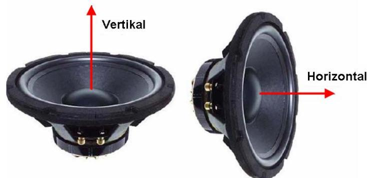
Bild 10.8: Messlage bei der Messung der TSP
