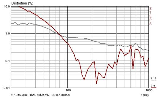
Bild 9.3: STEPS Klirrfrequenzgang eines 6“ TMT im Nahfeld (KE 4-211-2)
