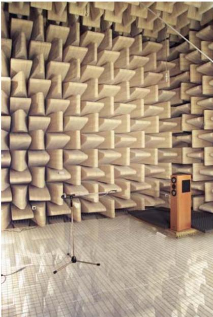
genannt. In einem RAR sind alle Begrenzungsflächen mit Schall absorbierendem Material - meist Glas- oder Mineralwolle - ausgekleidet. Um eine möglichst vollständige Schallabsorption im gesamten Nutzbereich zu erreichen, wird die Auskleidung häufig in Keilform ausgeführt (s. Bild 6.2.4).
