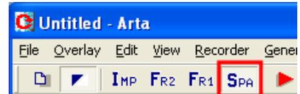
Starten Sie die Messung im **SPA**-Mode durch Drücken des Record-Symbole
