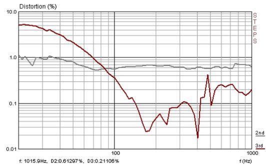
Bild 9.4: STEPS Klirrfrequenzgang eines 6“ TMT im Nahfeld (MB 550)
