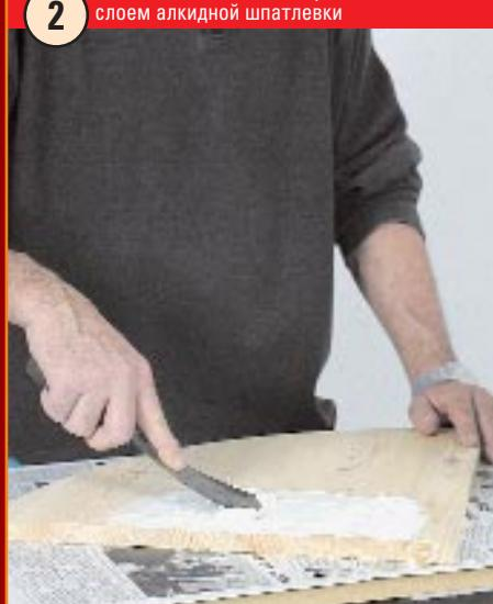
3 Прямые кромки равномерно замазываем шпателем...
