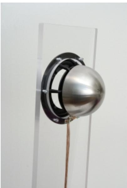
Магнитную систему закрыли колпаком из нержавеющей стали.
