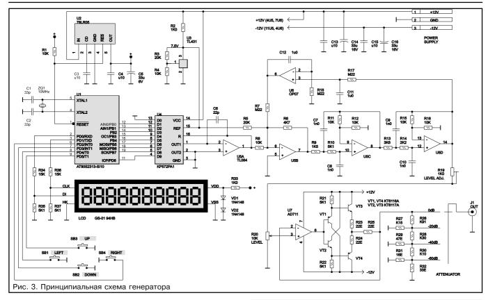
шаг сетки равен примерно 0,001 Гц. Реально используется шаг сетки 0,01 Гц, что позволяет ввести цифровую калибровку опорной частоты.
