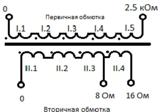
*Электрическая схема выходного трансформатора*
