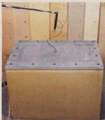
Die Messanordnung: Das zu testende Gehäusematerial wird mit dem Testgehäuse verschraubt, der Beschleunigungssensor mittig angebracht und das Messmikrofon genau 20 cm über der Oberfläche positioniert.
