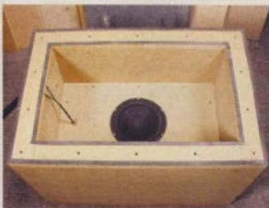
Das Testgehäuse ohne Materialprobe: Im Innern arbeitet ein 18-cm-Tieftöner, der den Probanden beschallt.
