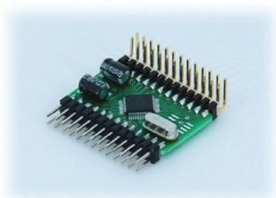
Модуль управления - собран на базе процессора LPC1114 (Cortex M0) фирмы NXP - отличительной особенностью является низкое энергопотребление и большое число портов ввода-вывода.
