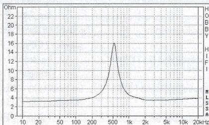
Extrem niedrige Resonanzfrequenz, kaum erkennbarer induktiver Impedanzanstieg, keinerlei Störungen.
