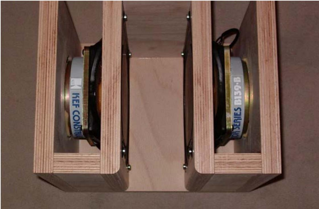
Die Dipol-Gehäuseform mit KEF B139:
