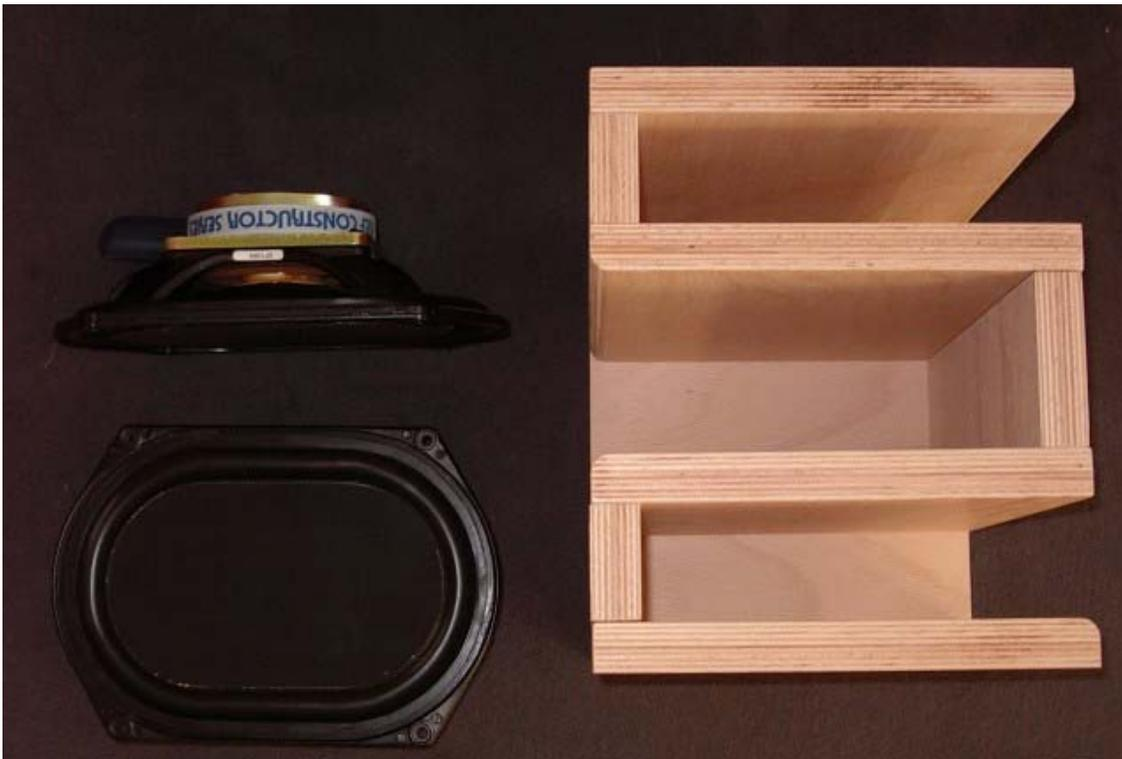
Die Dipol-Gehäuseform mit KEF B139:
